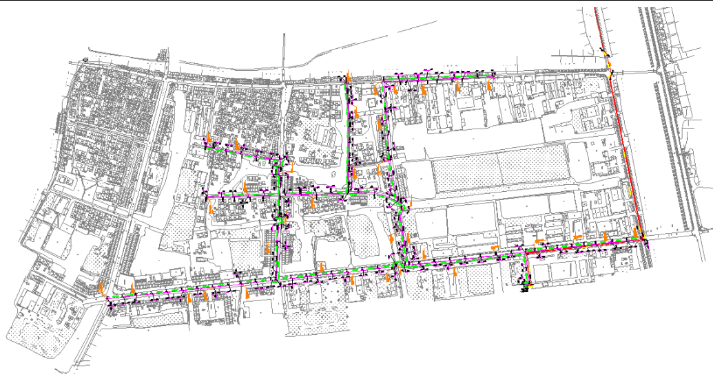
图 水泗片区污水挂网现状图
