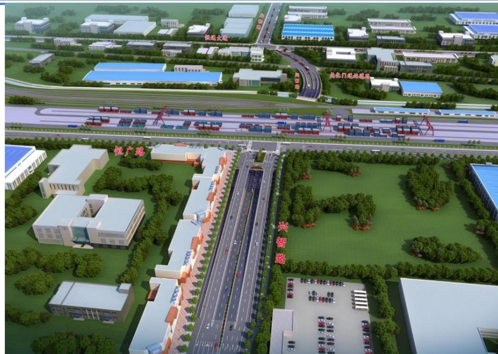
由直线、缓和曲线及圆曲线组成。圆曲线2处，圆曲线半径分别为350m、260m，半径260m处需设置超高。
