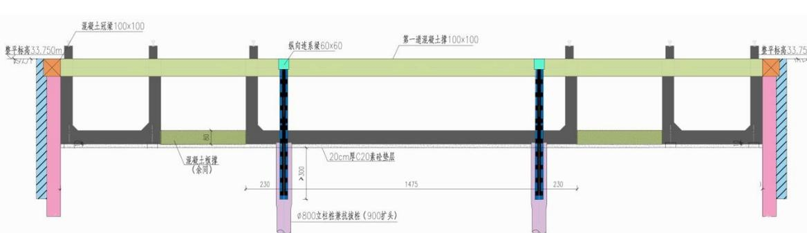
敞开段围护结构
