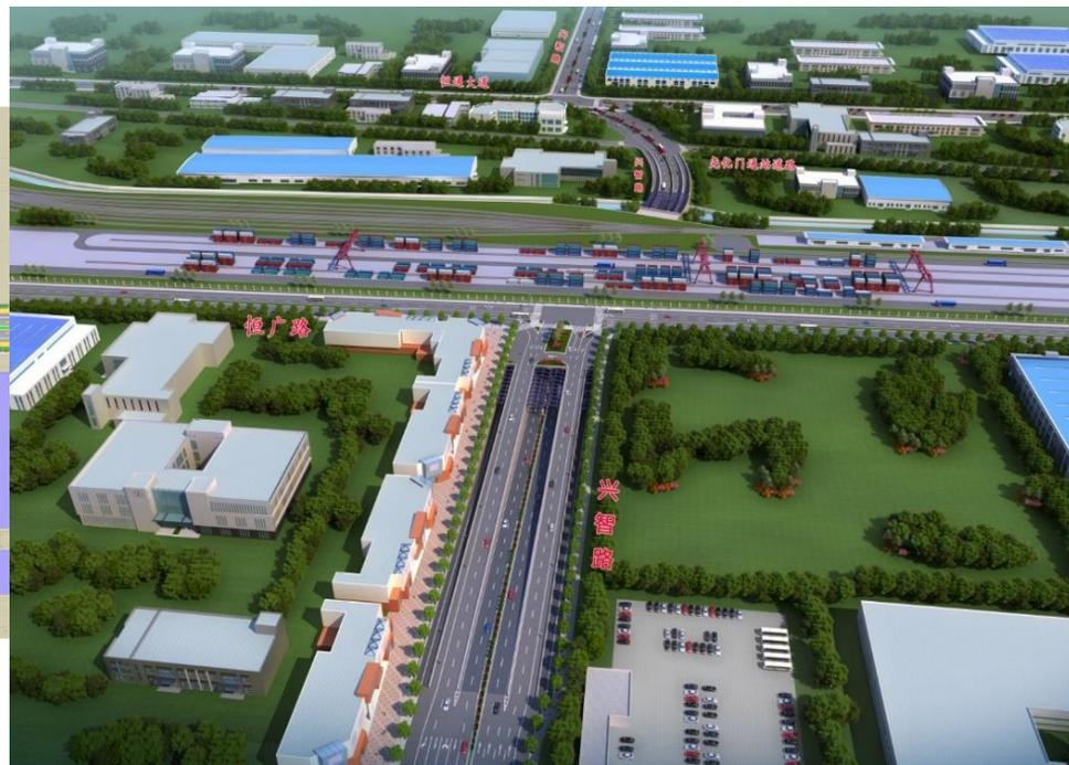
由直线、缓和曲线及圆曲线组成。圆曲线2处，圆曲线半径分别为350m、250m，半径250m处需设置超高和车道加宽。加宽值内侧小客车0.3m、外侧大客车0.4m。
