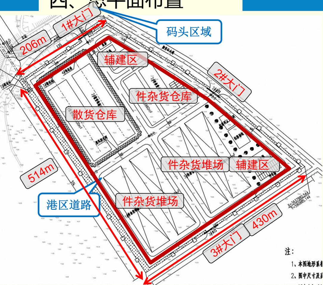
后方陆域可分为生产区和辅助区，生产辅助建筑物主要有仓库、转运站、综合办公楼、候工楼、机修及工具间、变电所、水池泵房等。道路采用环形布置，主干道宽15m，次干道宽10m，共设置3个出入口。
