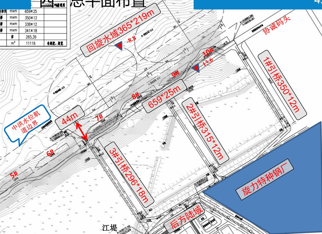
码头平台长度为659m，宽度为25m。码头平台通过3座引桥与后方现有江堤相接，其中，1#、2#、3#引桥尺度分别为350.97x12m、315.44x12m、296.05x18m。
