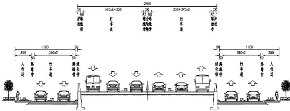
起点至高架桥桥头段道路标准横断面图
