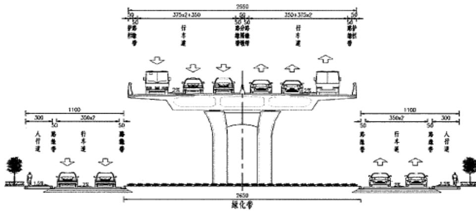
高架桥头至匝道起点段道路标准横断面图
