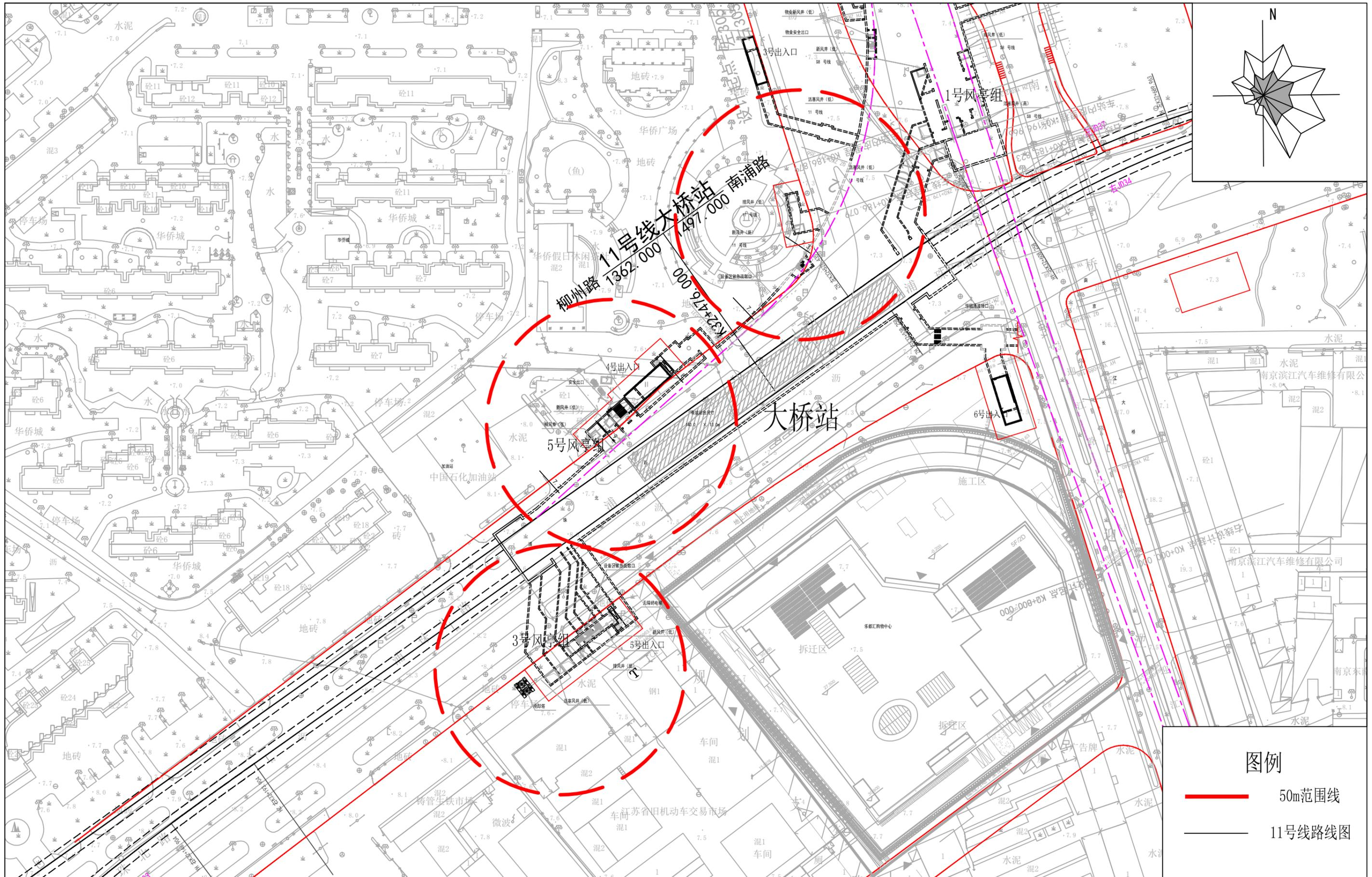
附图5-17 大桥站总平面图
