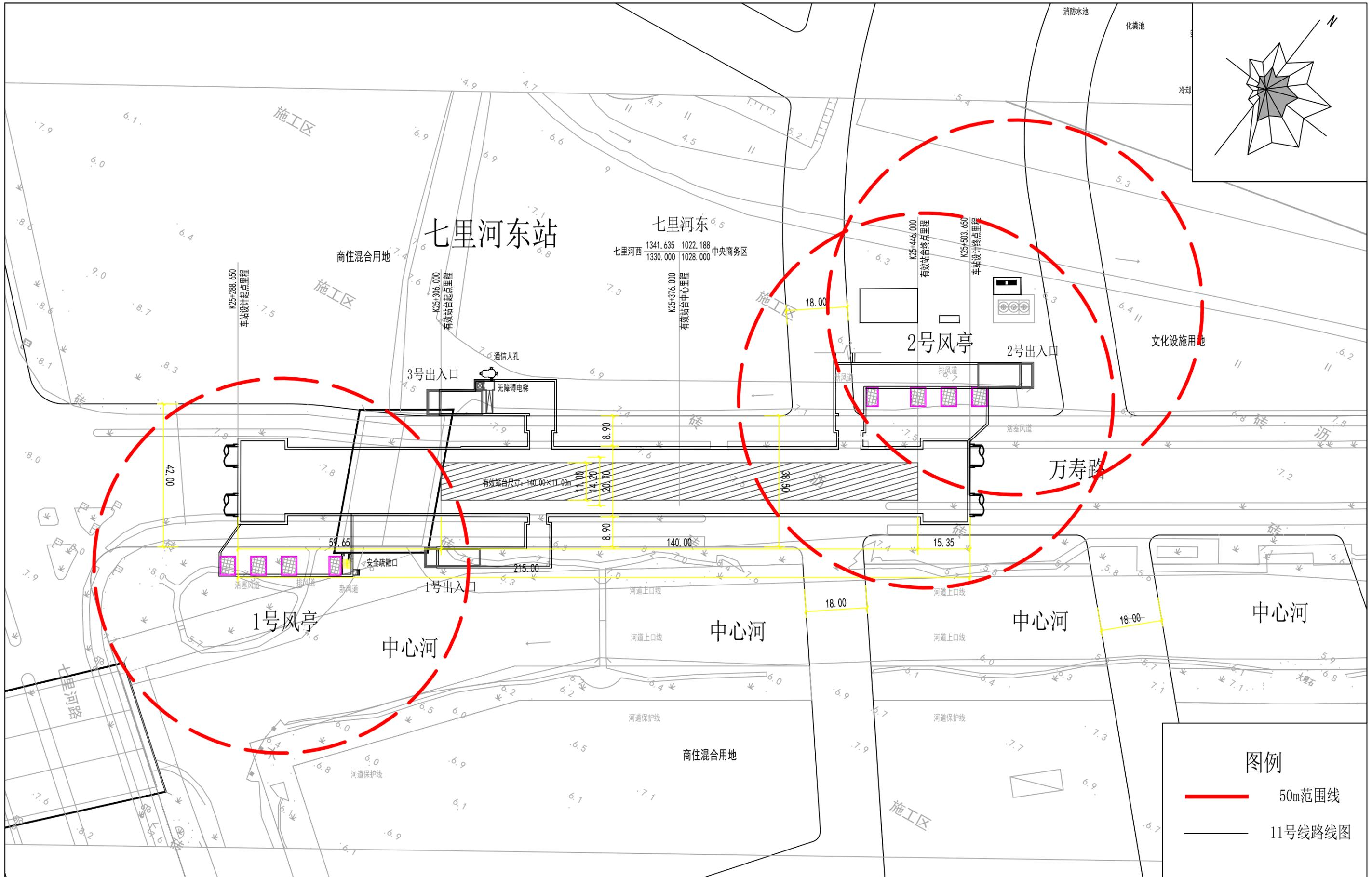
附图5-10 七里河东站总平面图
