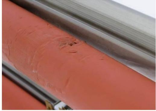
2) PE 护套中度破损
